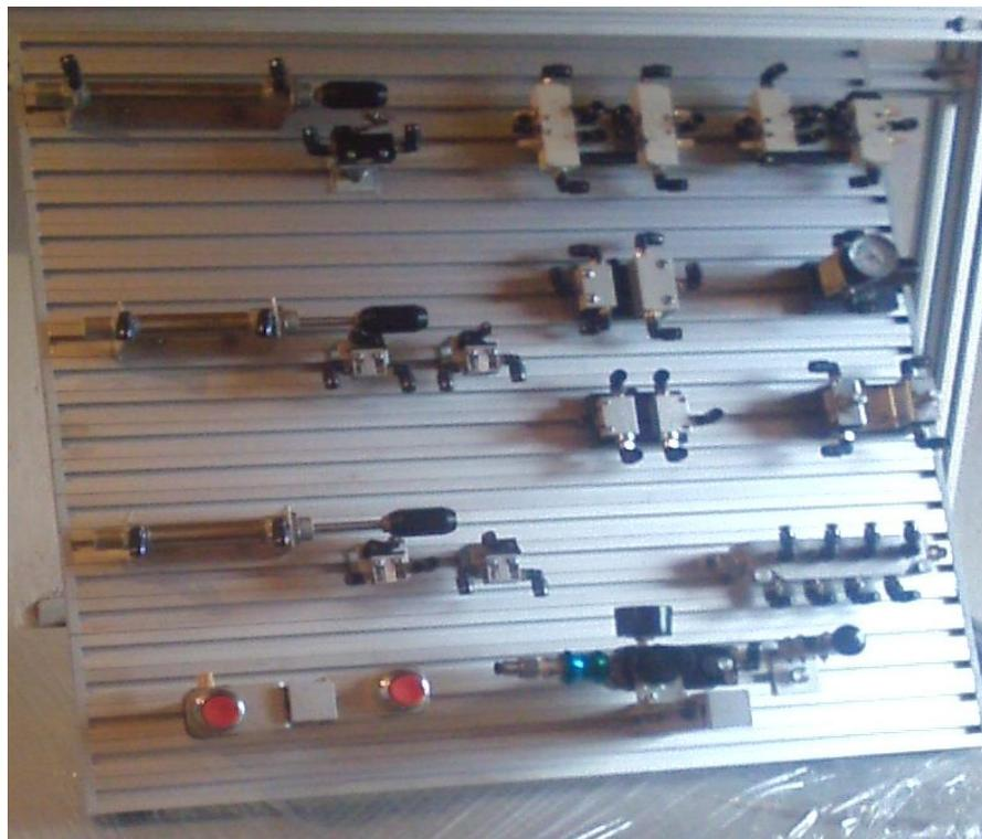
**Fig.1.6. Panel finalizado con elementos neumáticos**
