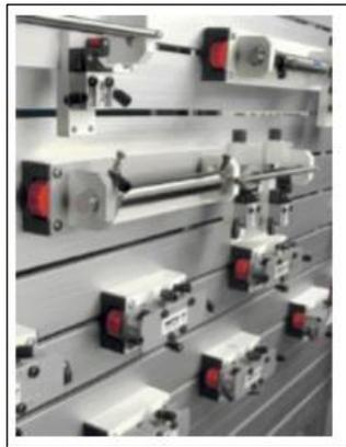
Fig. 2.2 Tablero neumático con componentes fijos.
