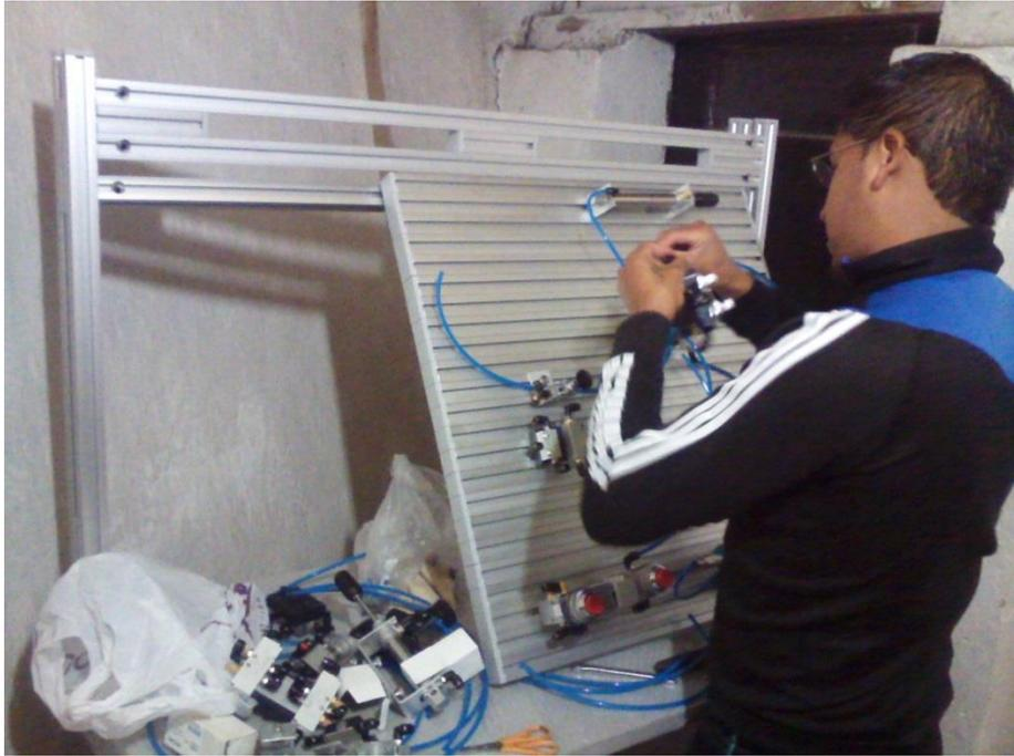
**Fig.1.5. Armado de circuitos neumáticos**
