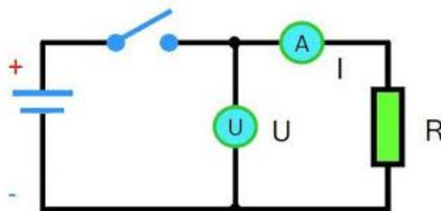
Un circuito eléctrico que tiene los componentes más básicos: Un generador o fuente, un dispositivo para abrir o cerrar el circuito (o llave) y un consumidor eléctrico, que tiene una resistencia interna (una lámpara)
