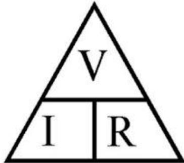
¿Qué pasa en todo circuito eléctrico? Al cerrarse un circuito, la tensión (V) aplicada provoca la circulación de una corriente de intensidad (I) a través de la resistencia (R).
